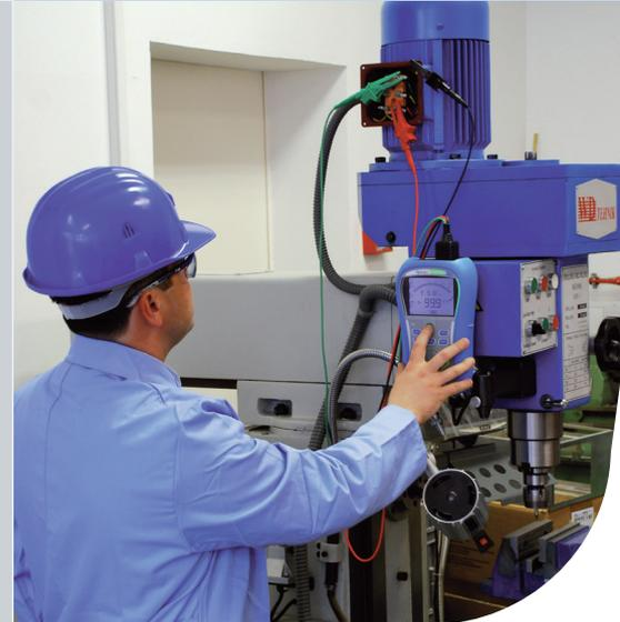
Das MI 3121H Smartec 2,5 kV Isolation / Durchgang ist das tragbare Messgerät für komplette Diagnoseprüfungen mit Isolations- und Durchgangsmessungen. Aufgrund der Messung des Isolationswiderstands mit Prüfspannungen bis zu 2,5 kV (Messbereich reicht bis zu 100 GΩ) und der Berechnung der PI- und DAR-Indizes ist das Gerät ideal für Prüfungen der Isolation von Kabelleitungen, Strom- und Spannungswandlern, elektrischen Motoren usw. geeignet.
