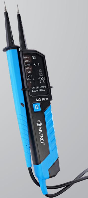
Die zweipoligen Spannungsprüfer werden gebaut und geprüft nach IEC/EN 61243-3:2014/VDE 0682. Die Spannungsanzeige erfolgt über helle LEDs, die in Bereiche von 12 - 690 V aufgeteilt sind, sowie zusätzlich als realer Effektivwert von 0 - 690 V in der LCD-Anzeige. Beide Modelle bieten Spannungsmessung, Durchgangsprüfung, einpolige Phasenprüfung sowie eine Drehfeldprüfung.
