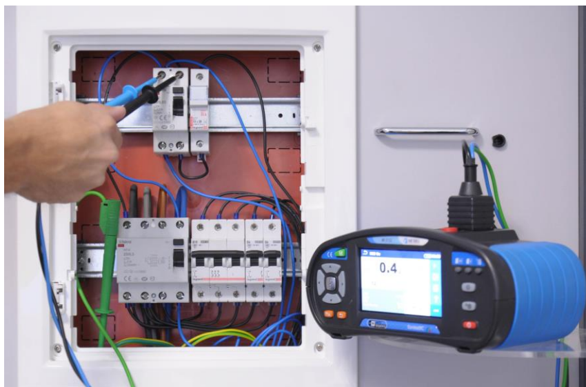
Abbildung 2-11: Schaubild für die Messung der Fehlerschleifenimpedanz - TT-System
