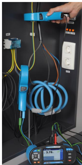
Abbildung 2-48: Erdungswiderstandsmessung mit der 3-Leiter-Methode
