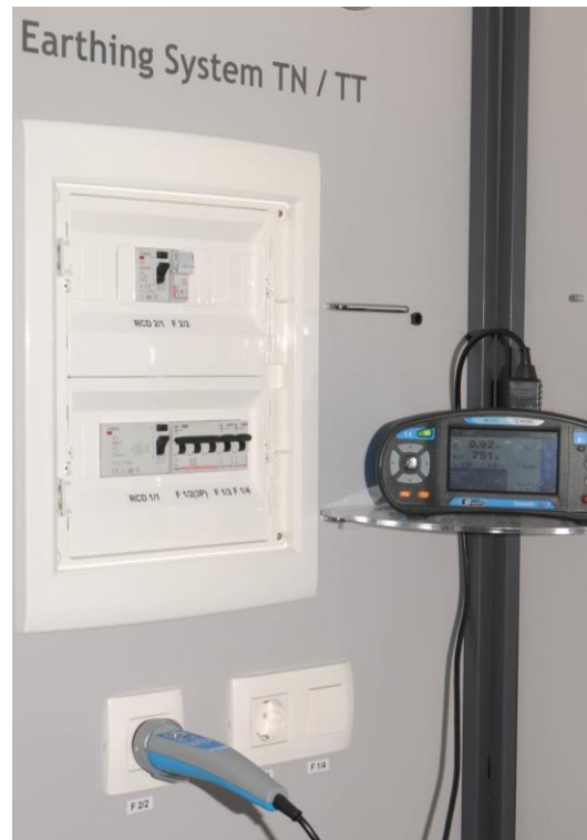
Abbildung 2-13: Messung Z_{Loop} im Application Trainer mit dem Schuko Commander
