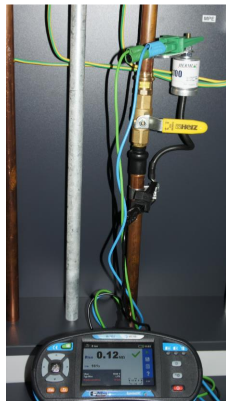
Abbildung 2-39: Isolationswiderstandsmessung am Varistor
