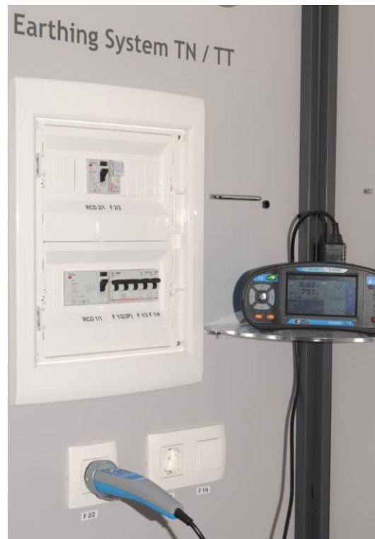
Abbildung 2-25: RCD Messung im Application Trainer mit dem Schuko Commander
