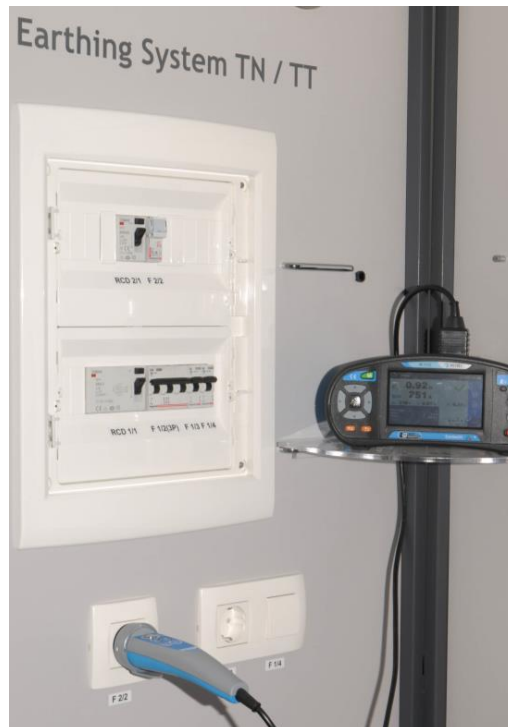
Abbildung 2-2: Messen von Z_{Line} im Application Trainer mit dem Schuko Commander
