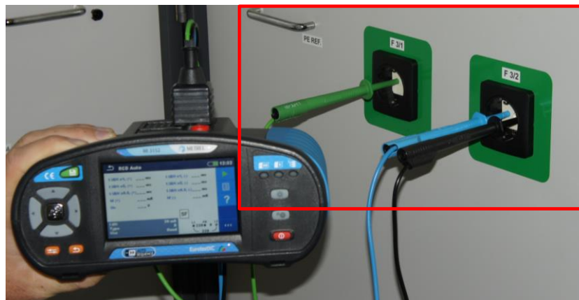
Abbildung 2-26: RCD Messung in einem IT Erdungssystem
