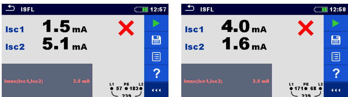
Abbildung 2-30: ISFL simuliert Fehler in einem IT System
