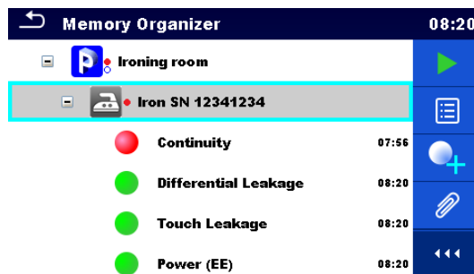
Abbildung 5.6: Status - Abgeschlossene Messungen mit fehlgeschlagenen Ergebnissen
