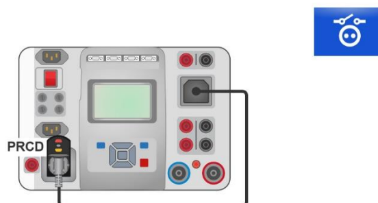
Abbildung 6.124: Anschluss des Commander-Prüfsteckers oder des 3-Leiter Prüfadapters (feste RCDs)
