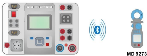
Abbildung 8.6: Anschluss des Leckageklemmenmessers mit Bluetooth®-Kommunikation
