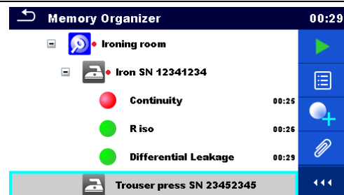
Abbildung 5.5: Status – Messungen abgeschlossen mit Ergebnis durchgefallen
