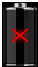
Abbildung 2.5: Batterie Fehleranzeige (Ladevorgang unterbrochen, Timer Störung Batterie fehlt)
