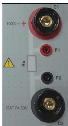
Abbildung 4.2: MicroOhm Strom- und Spannungsanschlüsse
