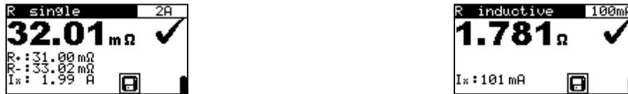
Abbildung 6.4: Beispiele für Ergebnisse von Widerstandsmessungen
