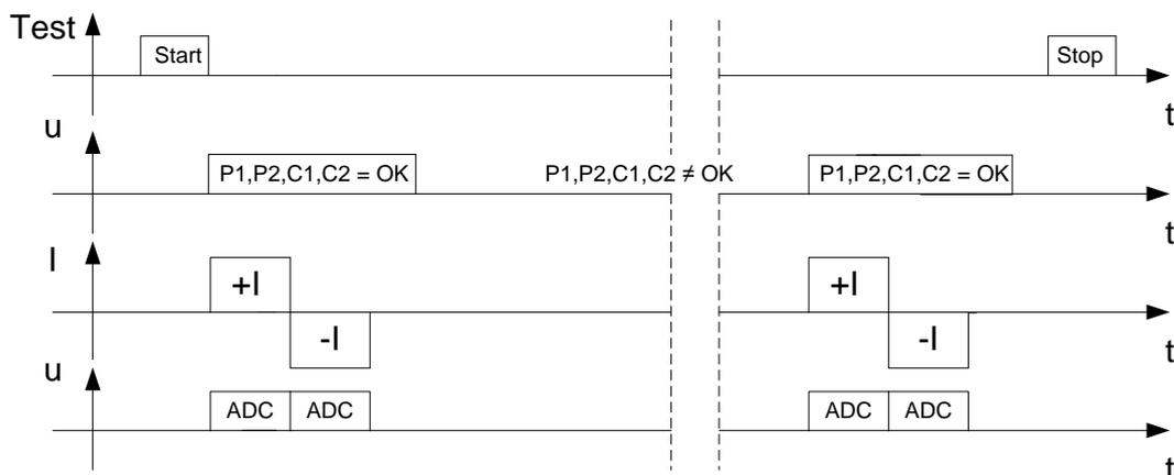
Abbildung 6.7: Automatischer Modus
