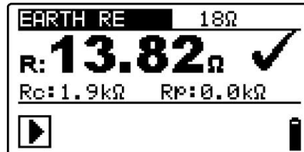
Abbildung 5.35: Beispiele für die Ergebnisse der Erdungswiderstandsmessung
