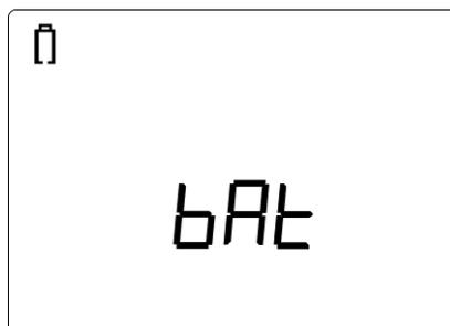
Bild 2.1: Anzeige „Batterie entladen“
