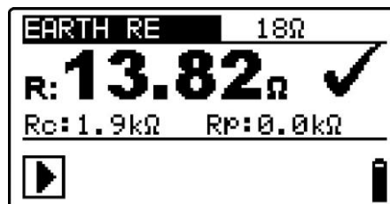
Abbildung 5.35: Beispiel des Ergebnisses einer Erdungswiderstandsmessung
