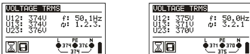
Abbildung 5.4: Beispiel für die Spannungsmessung in einem Drehstromsystem
