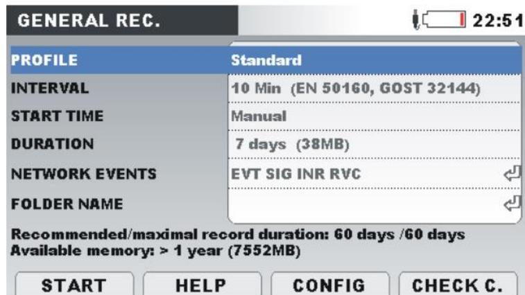
Abbildung 179: Vordefinierte Konfiguration des Rekorders nach EN 50160
