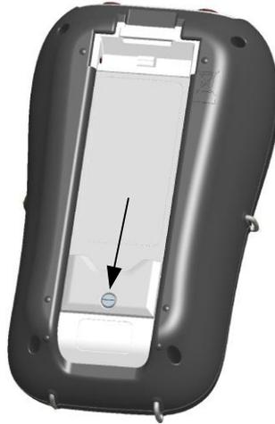
Abbildung 182: Schließen der Akkufachabdeckung
