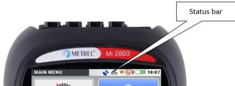
Abbildung 9: Statusleiste des Geräts
