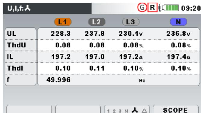
Abbildung 85: Bildschirm von der U,I,f-Messung in der aufgerufenen Momentaufnahme
