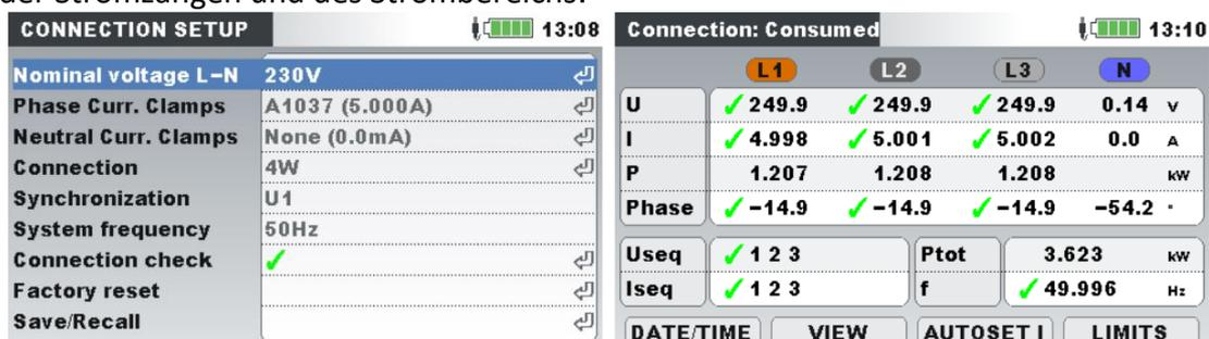
Abbildung 76: Einrichtungsanschluss und Anschlussprüfung am PQI
