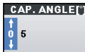
Abbildung 3.6: Strom eilt Spannung um einen Winkel von 5° voraus.
