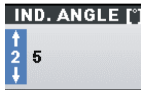
Abbildung 3.5: Strom eilt Spannung um einen Winkel von 25° nach.
