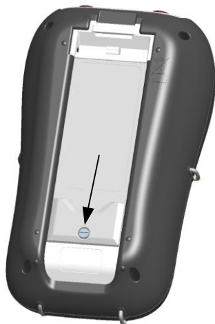
Abbildung 7.2: Schließen der Batteriefachabdeckung
