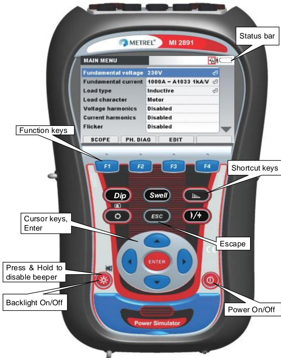
Abbildung 3.1: Beschreibung der Symbole auf dem Display und der Tasten
