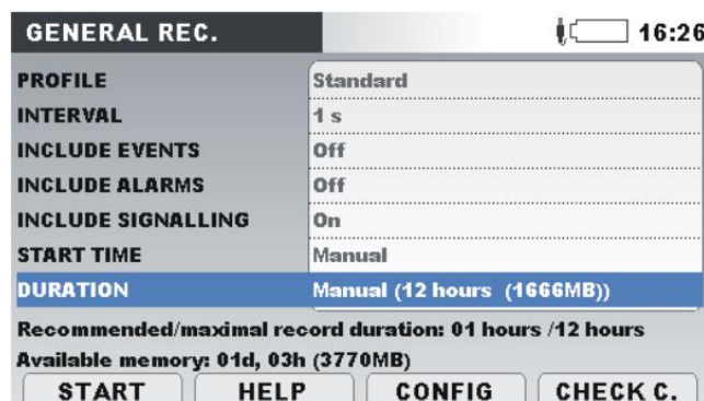
Abbildung 7.1: Einrichtung des allgemeinen Rekorders, um den Neustart der automatischen Aufzeichnung zu ermöglichen, wenn diese die maximale Dateilänge erreicht
