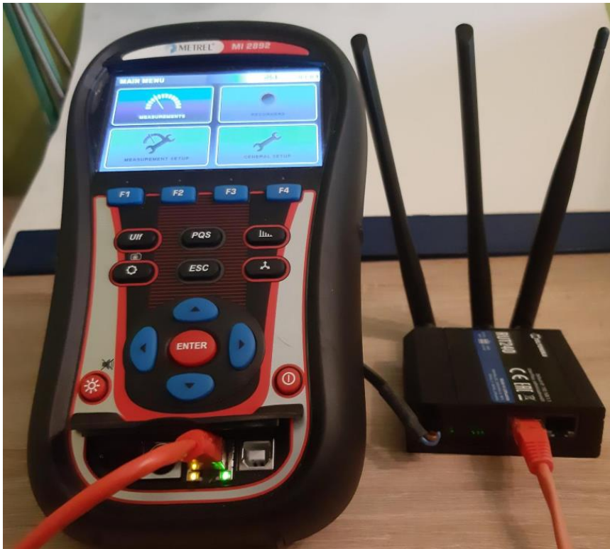
Abbildung 10: Verbindung von Router und MI 2892
